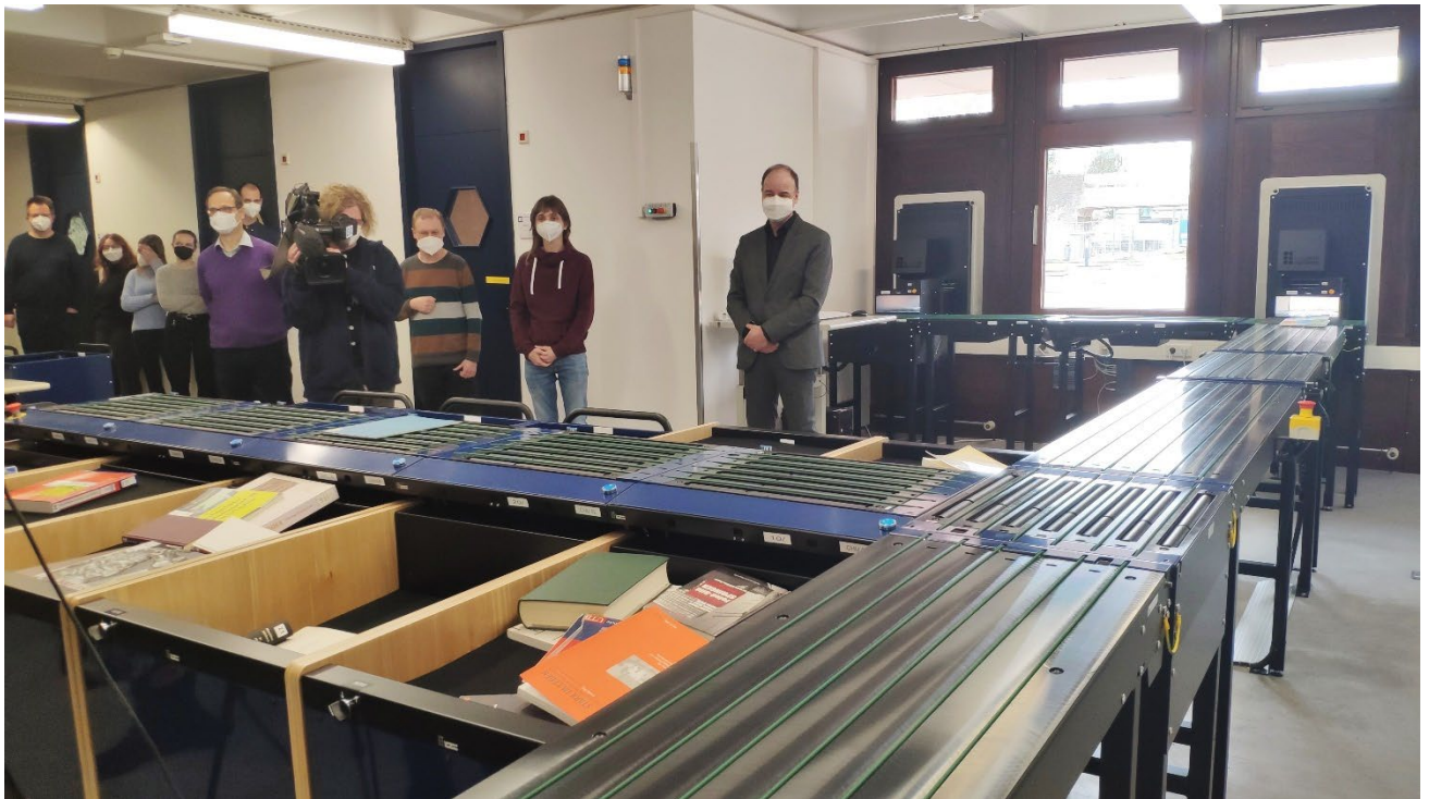
Die Rückgabe- und Sortieranlage in Betrieb: Medien werden über das Förderband transportiert und automatisch rückgebucht und in Containern vorsortiert.
